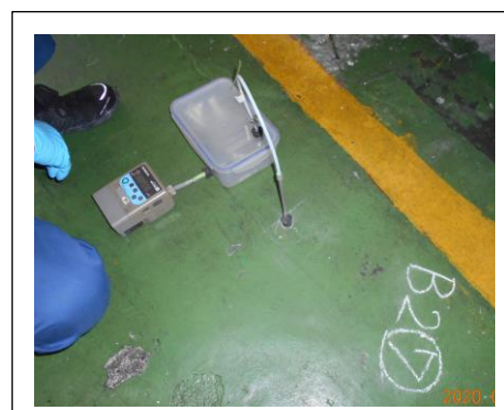
機械工場の土壌ガス調査
